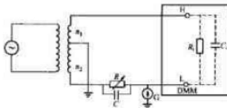
图 17 交流电压输入阻抗测试
