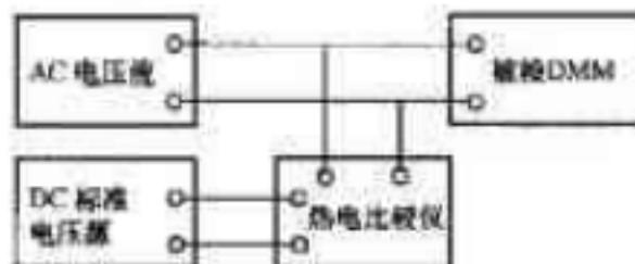
图 8 热电比较法接线
