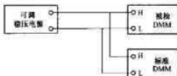
图 3 直接比较法接线
