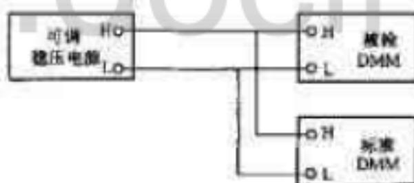
图 7 比较法检定接线
